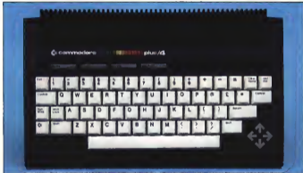
La completa tastiera del Plus II. Notare i tasti funzione, posti in alto a sinistra, e quelli che controllano il canale, configurati come frecce a destra, in basso a destra.
